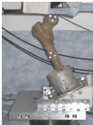
图 1 股骨颈骨折循环加载图
