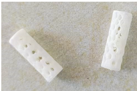
图 1 3D 打印羟基磷灰石/丝素蛋白/聚乳酸人工骨支架
