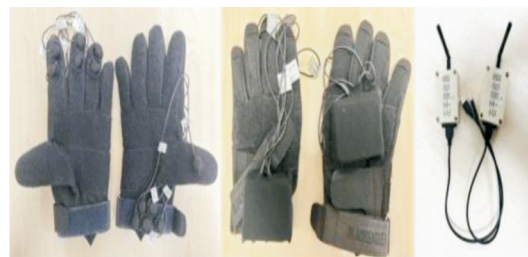
图 1 智能力学采集手套和数据传输设备
